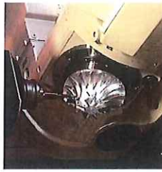
付加2軸傾斜インデックステーブルを使用した3次元輪郭加工ワーク：アルミニウム合金材料：アルミニウム合金
