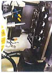
付加1軸インデックステーブルを使用した4面加工ワーク：シリンドリッド材料：アルミダイカスト
