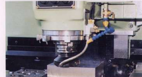
φ125正面フライスによる加工(S45C)
