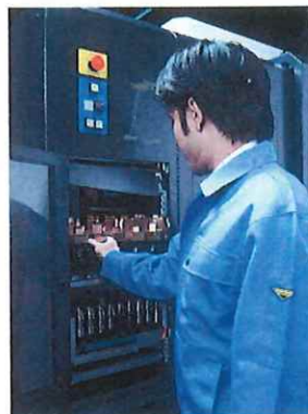
↑ 工具、ワークの交換は機械正面位置から可能です。
