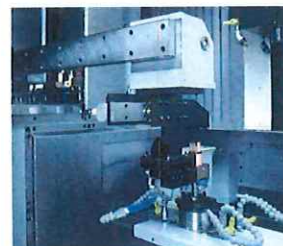
↑ 内蔵オートワークチェンジャ20本は機械左側のATC60本ユニット上部に配置、上下空間を有効に使い究極の省スペース化を実現。
